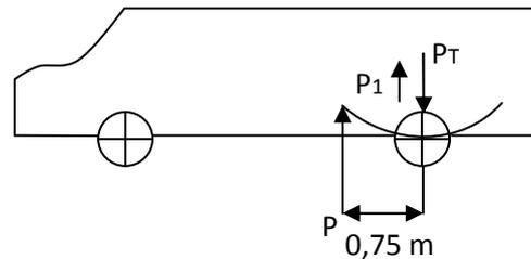
$KB = 170 \text{ Kp/cm}$ , esto sería si hubiésemos colocado el gato en el eje trasero, pero se ha puesto en el extremo interior de la ballesta.
