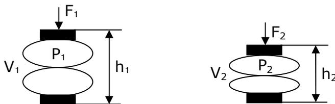
Se puede considerar que el proceso de compresión de los muelles neumáticos se desarrolla sin intercambio de temperatura al exterior, por ser la compresión y descompresión muy rápida, es decir, es un proceso adiabático (sin intercambio de calor).
